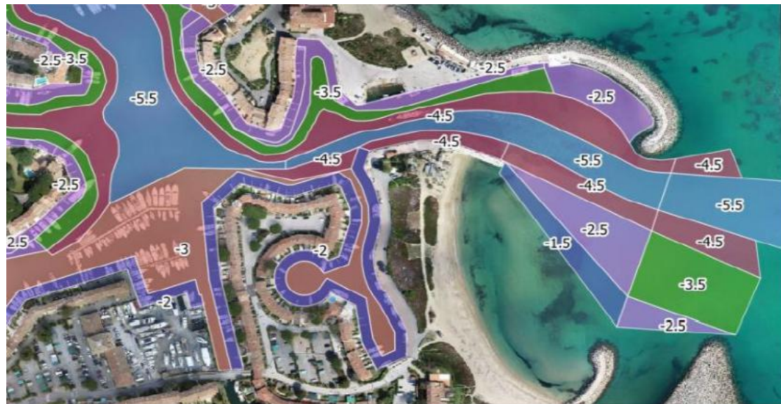
Cotes d'origine mise en place à la construction de Port-Grimaud – 5 mètres au milieu du chenal
