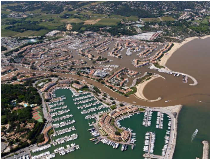
Photo aérienne illustrant l'ensablement récurrent de la passe d'entrée : à la suite d'une crue majeure de la Giscle en mai 2025, les sédiments transportés par le fleuve ont été orientés vers Port-Grimaud
